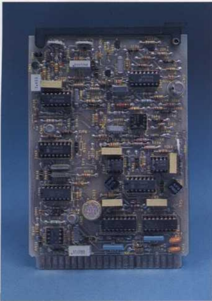
Elektronik im Europakartenformat am Beispiel der Regelplatine
